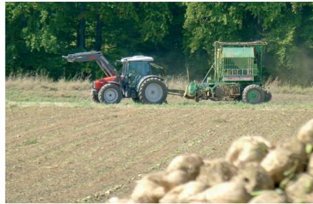
*Bis in die 1990er Jahre hinein wurde die hier zu sehende Rübenerntemaschine gebaut. Die Rüben werden in einem Arbeitsgang aus dem Boden geholt, geköpft und in einem Bunker gesammelt (Rübenvollernter). Sie kann drei Rübenreihen gleichzeitig abernten und muss von einem Schlepper gezogen werden.*
