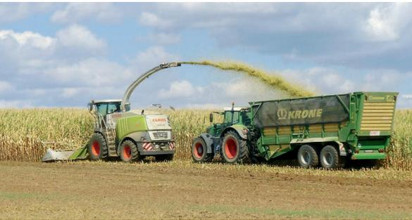
*Bei der Nutzung für die Biogasanlage oder zur Futtererzeugung wird die ganze Maispflanze verwendet. Das Erntegut wird in einem Arbeitsschritt abgeschnitten, gehäckselt und auf einen Anhänger verladen.*
